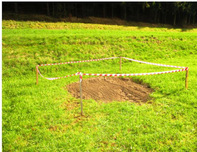
Bild 2: Dolineneinbruch W Mittelreinbach (Foto Ernst Klann vom Frühjahr 2016) (6435/D073)
